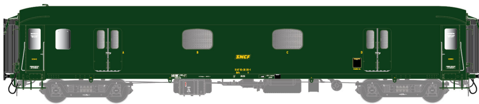
31 202 Dd4s 51 87 95 30 191-1 SNCF région 2 Nord, 140 Km/h, sans échelles de bout, Ep.IV Nouvelle référence
